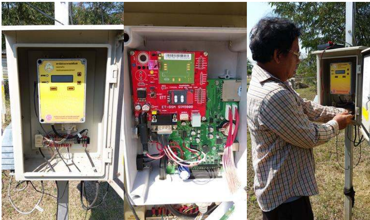
ภาพที่ ๑๐ เครื่องตรวจอากาศอัตโนมัติ (Data logger) จากสถานีตรวจวัดอากาศอัตโนมัติ ณ ศูนย์วิจัยข้าวแพร่
